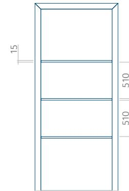
Die Platte ist in einer Version mit einer schmaleren Nut (6 mm) erhältlich, in der es keine INOX-Anwendung gibt – Plattenmuster 111, während dieses Muster in der Holzplatte eine 4 mm Nut hat.
