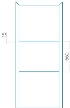
Die Platte ist in einer Version mit einer schmalen Nut (6 mm) erhältlich, in der es keine INOX-Anwendung gibt – Plattenmuster 109, während dieses Muster in der Holzplatte eine 4 mm Nut hat.
